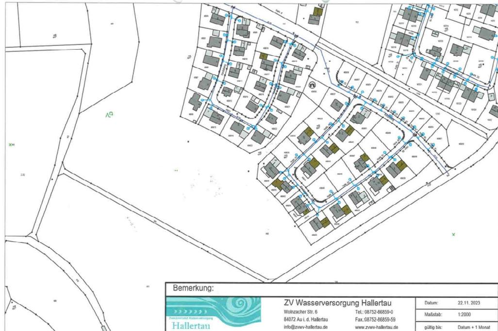
Abbildung: Lageplan über die bestehenden Versorgungsleitungen. ZV Wasserversorgung Hallertau.
