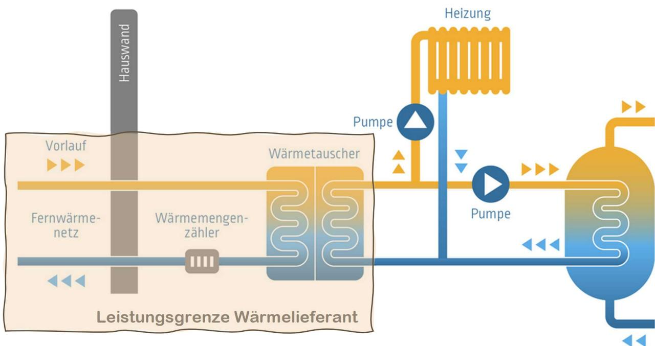
Die Übergabestation enthält auch die Steuerung der Kunden-Heizungsanlage samt Warmwasserbereitung.
